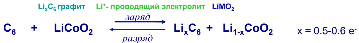
Напряжение: 3.6 в     $E^\circ$  (cathodic) –  $E^\circ$  (anodic) =  $E^\circ$  (cell)
