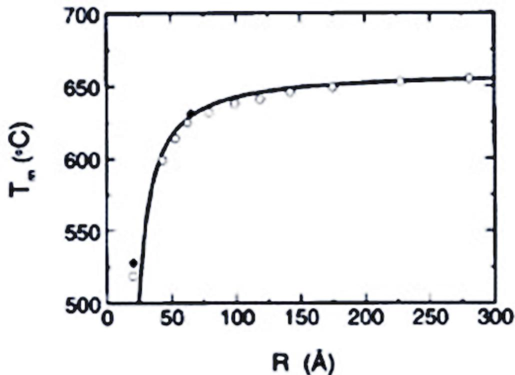
Зависимость температуры плавления алюминия  $T_m$  от радиуса наночастиц  $R$  (в ангстремах).
