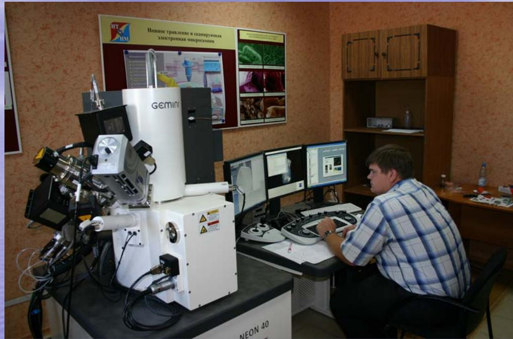
Высокоразрешающий двухлучевой электронно-ионный микроскопический комплекс *Neon 40* (Carl Zeiss, Германия), снабженный энергодисперсионным рентгеновским спектрометром *INCAx-act* (Oxford Instruments, Великобритания)
