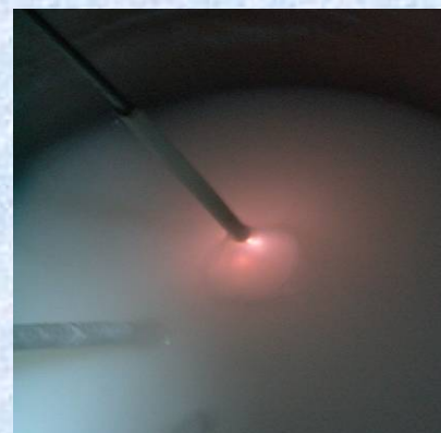
Процесс микродугового горения
